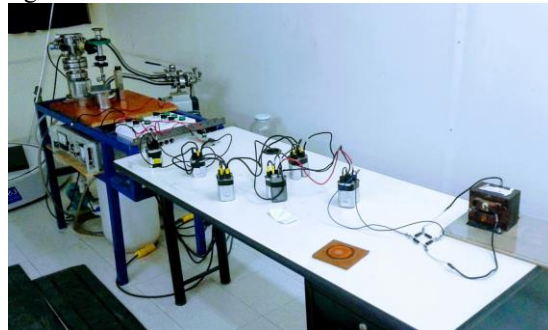
Figura 8. Montaje de la fuente sputtering y el sistema de vacío y cámara.
