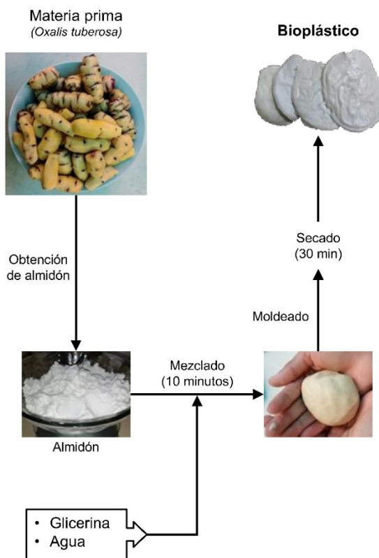
Fig. 1. Esquema del proceso de elaboración de los bioplásticos a base de almidón de oca.
