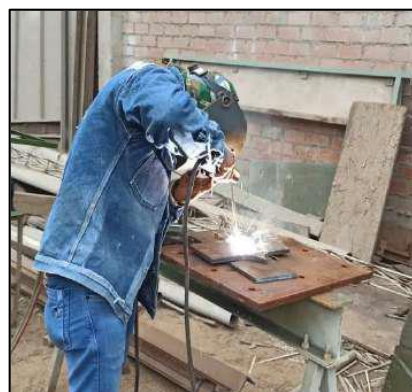
Fig. 3 Proceso de soldadura de las probetas.
