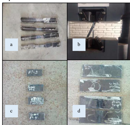
Fig. 5 Medición de dureza y resistencia: a) Probetas seccionadas, b) Desbaste de probetas, c) Pulido de probetas y d) probetas de dimensiones seccionadas de 70 x 30 x 12 mm.
