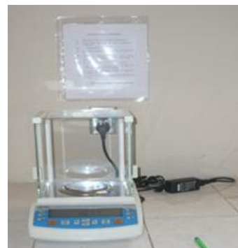
Fig. 3 Balanza Sartorius, 0.1 mg
