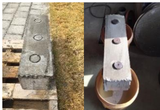
Fig. 3 Ensayos de adherencia – Viga elaborada
