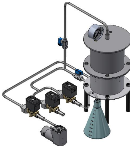
Fig. 1: Nariz electrónica construida por el Grupo GICA-PUCP
