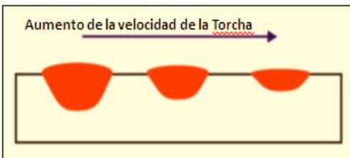
Fig. 6. Aumentando la velocidad de avance disminuye el cordón.
