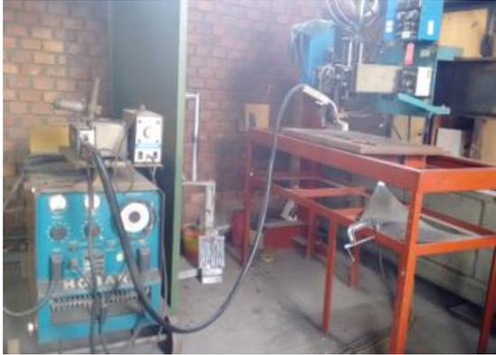
Fig.12. Implementación de la pistola GMAW al sistema de velocidad del proceso SAW.
