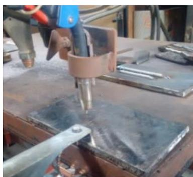
Fig.14 Elaboración de cordones en las probetas [20]
