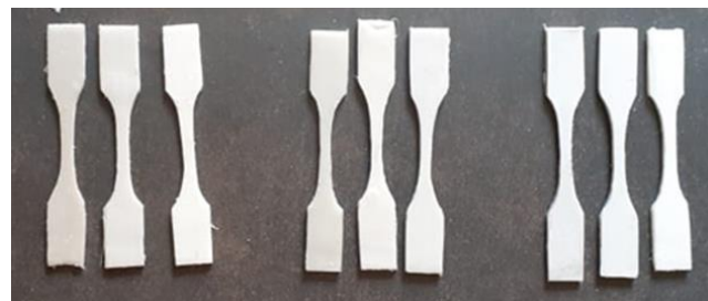
Fig. 2 Probetas confeccionadas para ensayo de tracción según ASTM D638 – 14 tipo IV
