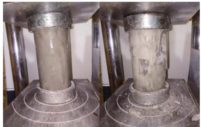
Fig. 5 Ensayo de resistencia a la compresión antes y después de la rotura.
