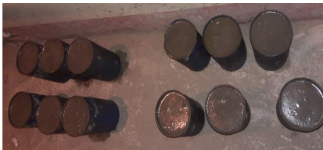
Fig. 3 Proceso de curado de las probetas
