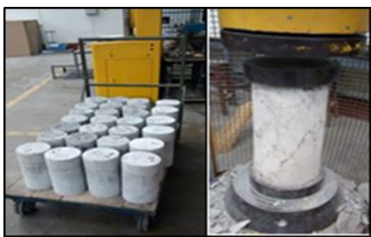
Fig. N° 5: ensayo de compresión axial en el laboratorio LEM N°1 FIC-UNI
