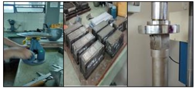
Fig. N° 03: Ensayo de fluidez, moldes cúbicos y ensayo de compresión.
