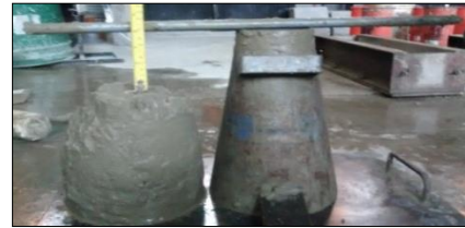
Fig. N° 04: Medida del asentamiento con PET
