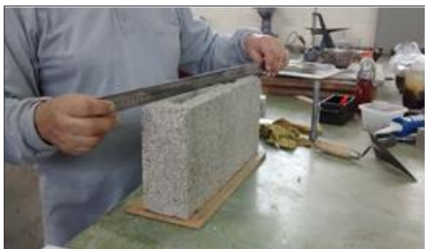
Fig. N° 9: medición del tamaño del bloque de concreto en el laboratorio LEM
