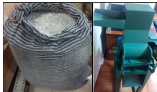
Fig. N°2: PET triturado y máquina trituradora
