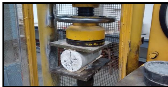
Fig. N° 6: Se observa e momento del ensayo a la tracción diametral en el laboratorio LEM N°1 FIC-UNI
