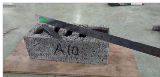
Fig. N° 12: Medición del tamaño del ladrillo de concreto En el laboratorio LEM N°01 FIC-UNI
