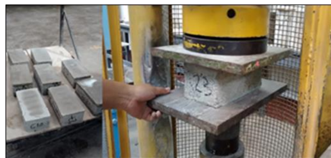
Fig. N° 11: Ensayo de compresión del ladrillo de concreto
