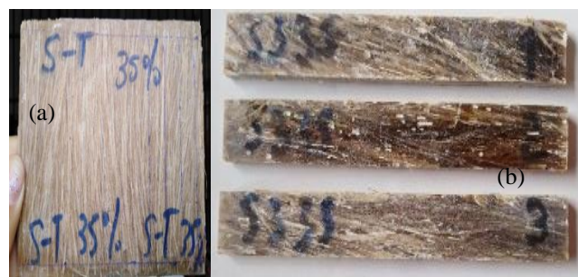
Fig. 1 (a) Placas de compuestos obtenidos, (b) muestras de probetas para ensayo de impacto (EN ISO 179-01).
