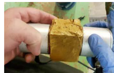
Fig. 6. Ensayo de ultrasonido Fuente propia
