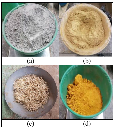
Fig. 4. Materiales utilizados para la elaboración del mortero: (a) Cemento, (b) Arena, (c) Fibra, (d) Pigmento. Fuente propia
